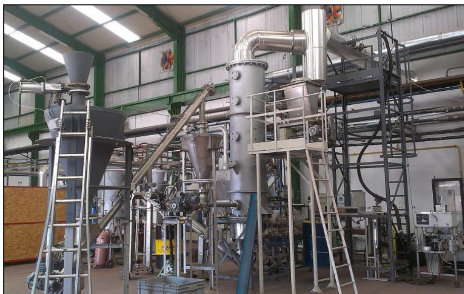
Figura 4: Planta piloto de gasificación con lecho burbujeante de 100kWt (CEDER).
