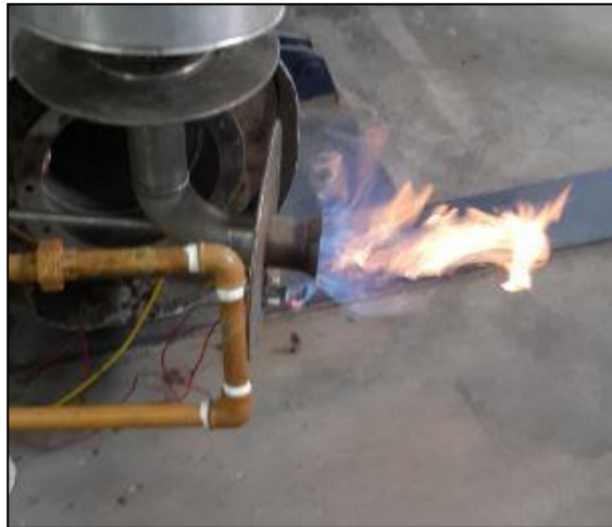
Figura 27: Llama lograda con el quemador fuera de cámara de combustión.
